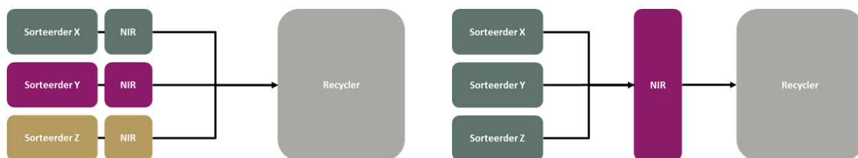
Figuur 5. Schema opties van nasortingsvestiging
